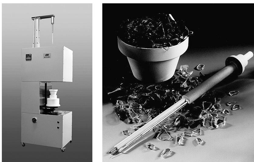
Figure 12 - Rapidox® の off-line システム装置と酸素センサーの写真
