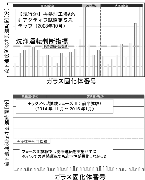
図5 流下速度が50 kg/hに到達する時間 アクティブ試験（上）、K2MOC試験フェーズⅡ（下）
