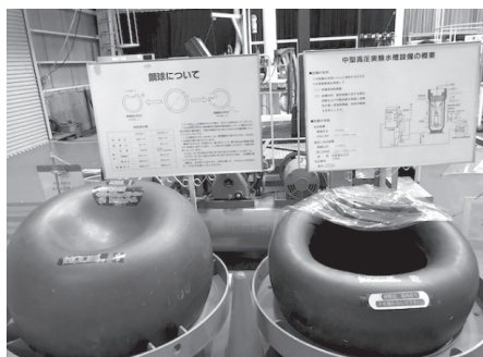
写真2 水圧で変形させた高張力鋼の球体
