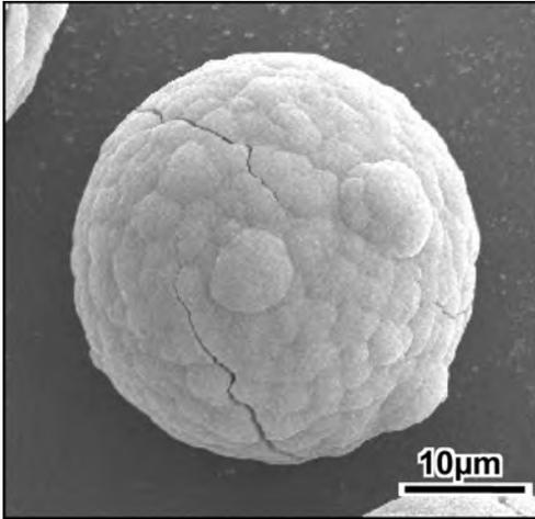
図4 Fe<sub>3</sub>O<sub>4</sub> 微小球の走査型電子顕微鏡写真
