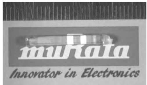
図 3 レーザ FZ 法で育成した TAG 単結晶の例
