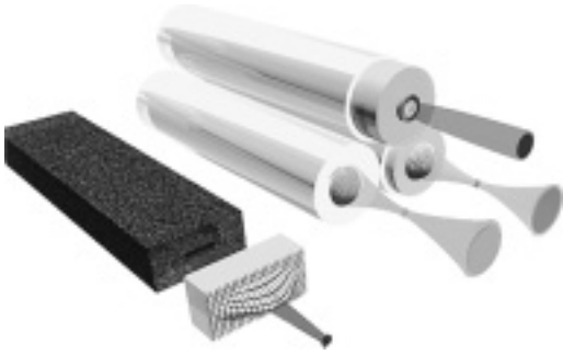
図1 半導体レーザーおよび光ファイバーと一体化マイクロレンズ [3]。
