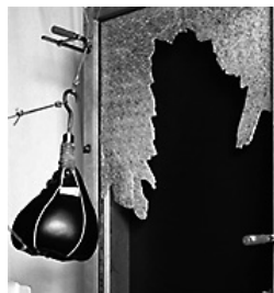
図1 試験枠(締め付け枠は図示していない)
