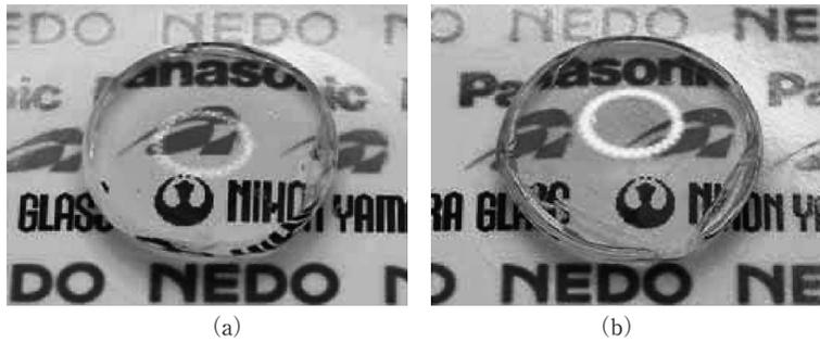
図 11 ZnO-Bi<sub>2</sub>O<sub>3</sub>-P<sub>2</sub>O<sub>5</sub>系ガラスの成型品の外観写真 (a) 反射防止構造有り, (b) 無し
