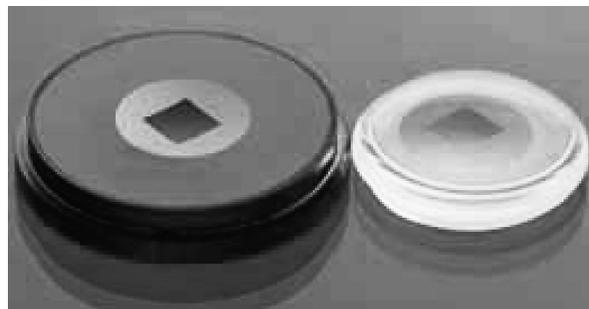
図 12 電子線描画により作製した (a) SiC レンズモールド, (b) 成型レンズ
