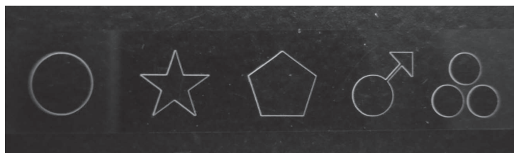
図5 超短パルスレーザで加工したガラスリボン
