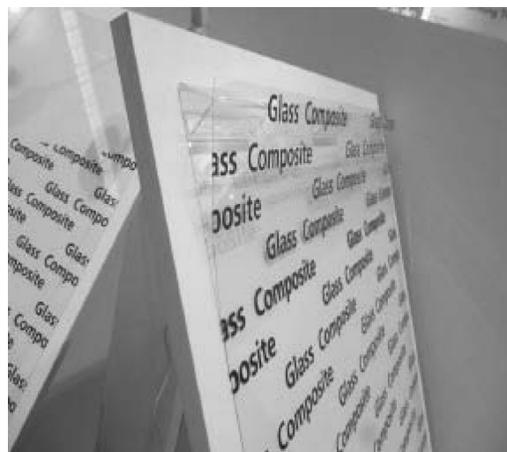
図6 G4サイズのキャリア積層した超薄板ガラス
