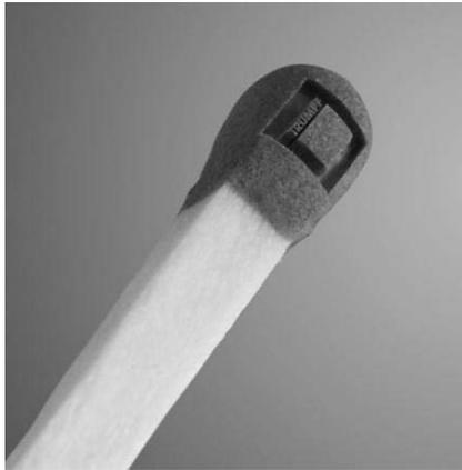
図1 超短パルスレーザーを用いた非熱加工（マッチへのエングレージング）
