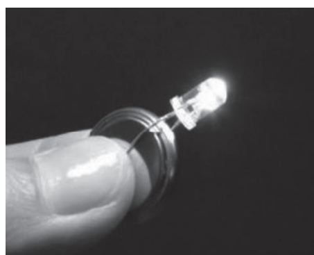
図3 作製した電池によるLED点灯テスト
