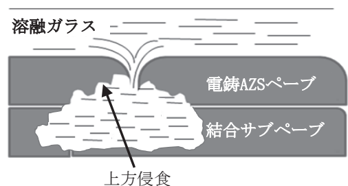
図4 ペーパー煉瓦の異常侵食(上方侵食)
