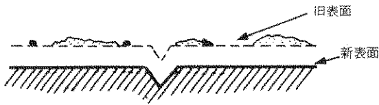
Fig. 3 エッチングによる潜傷の発現
