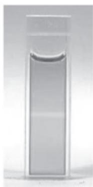
図 1 ナノ粒子分散液 (Ni-Al 系 LDH) の写真。アメリカ化学会 (ACS) の許可を得て *ACS Nano* 2016, 10, 5550-5559 より転載
