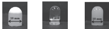
HA:MA = 10:0 HA:MA = 3:7 HA:MA = 0:10 図5 ポリスチレンと ZrO_2 NPs (30wt%) のハイブリッド材料の光学写真
