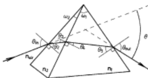
図2 ダブルプリズムによる最小偏角法の概念図 4)
