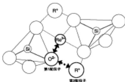
図5 アルカリケイ酸塩ガラスにおける \text{Nd}^{3+} 周辺の局所構造
