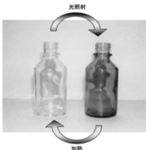
図1 \text{Mn}^{2+} \leftrightarrow \text{Mn}^{3+} の変化を利用したガラスびんの着脱色
