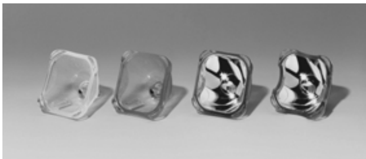
図5 ハイテクリフレクタの製造工程。左から、プレス成形されたグリーン・ガラス、結晶化ガラス、PICVDによる成膜後、および後加工した完成品。
