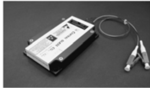
写真3 \mu -EDFA：名刺よりも小さい W45×D70×t12 mm に EDFA としての機能を凝縮。
