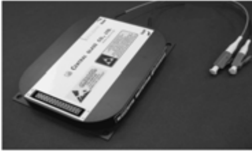
写真4 Mini-EDFA: MSA サイズ (W70×D90×t12 mm) で波長多重増幅が可能。
