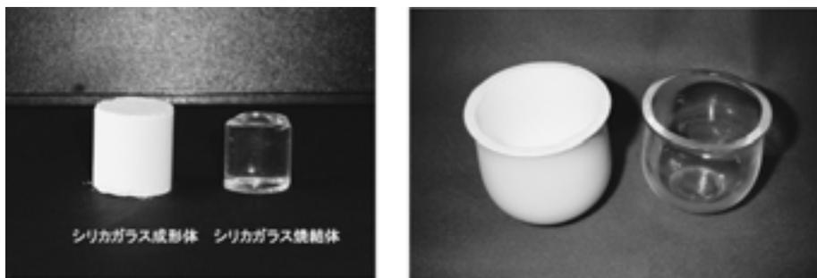
図9 成形体と透明ガラス焼結体（それぞれ左側：成形体，右側：ガラス焼結体）
