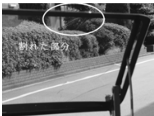
写真1 合わせガラス破損時の視界 (破損時も視界良好)
