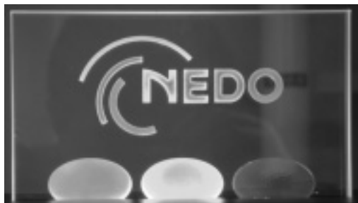
図4 ナノ粒子分散ガラスを用いた多色発光表示
