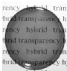
図1 多孔質ハイブリッド導電膜の模式図と外観
