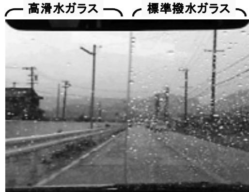
図5 雨天走行時の雨滴飛散性
