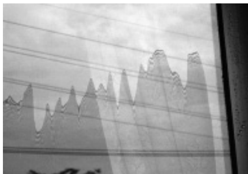
図2 光触媒ガラス表面の水膜形成
