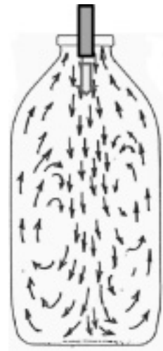
図14 ブローエアの流れ実験結果
