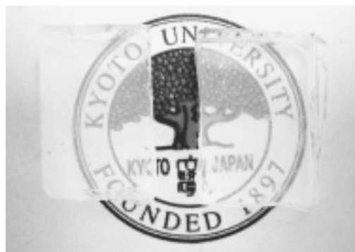
図3 左はMTMS-F 127系で作製した超臨界乾燥エアロゲル、右は常温・常圧下における溶媒の蒸発乾燥によって得られたキセロゲル。
