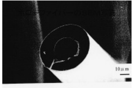
写真1 多孔質ガラスホローファイバーのSEM写真
