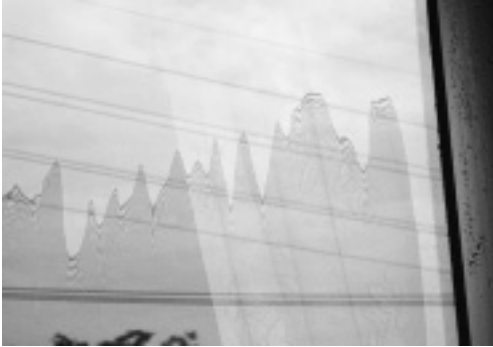
図4 光触媒ガラス表面の水膜形成
