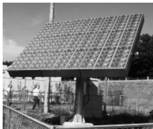
写真1 NEDO 技術開発機構 大規模電力供給用太陽光発電系統安定化等実証研究を実証する山梨県北杜市の北杜サイトにて撮影したシャープ社追尾型集光太陽電池モジュール写真
