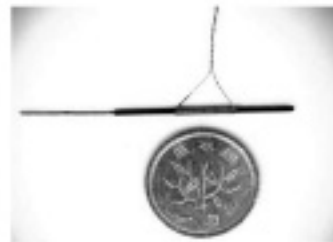
図4 多孔質ガラスキャピラリーによる発電セル 5)
