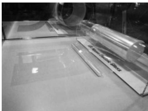
図1 超薄板ガラスのロール巻の写真
