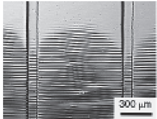
図2 PDMS表面に金属膜を蒸着し（@200℃）室温に冷却することにより表面しわを形成できる（左）。PDMSに溝を形成し応力蓄積に異方性を付与することによりグレーティング構造を形成できる（右）。(Ref. 1)
