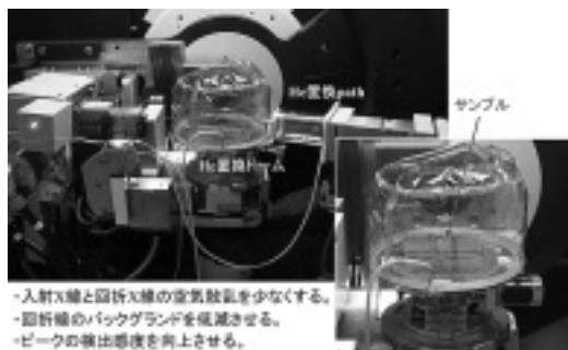
図8 回折X線の強度を向上させるためのHeガス置換の治具を装着したX線回折
