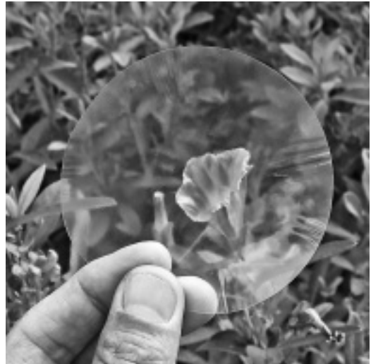
図3 半透明セルロースナノファイバーシートと表面研磨した透明セルロースナノファイバーシート
