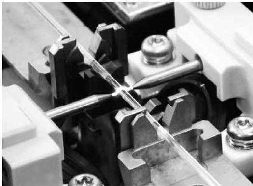
写真 5 . 放电がファイバの上面に逃げている
