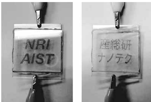
図4. 柄切替え素子。英字、日本語の表示をスイッチひとつで切替え可能。
