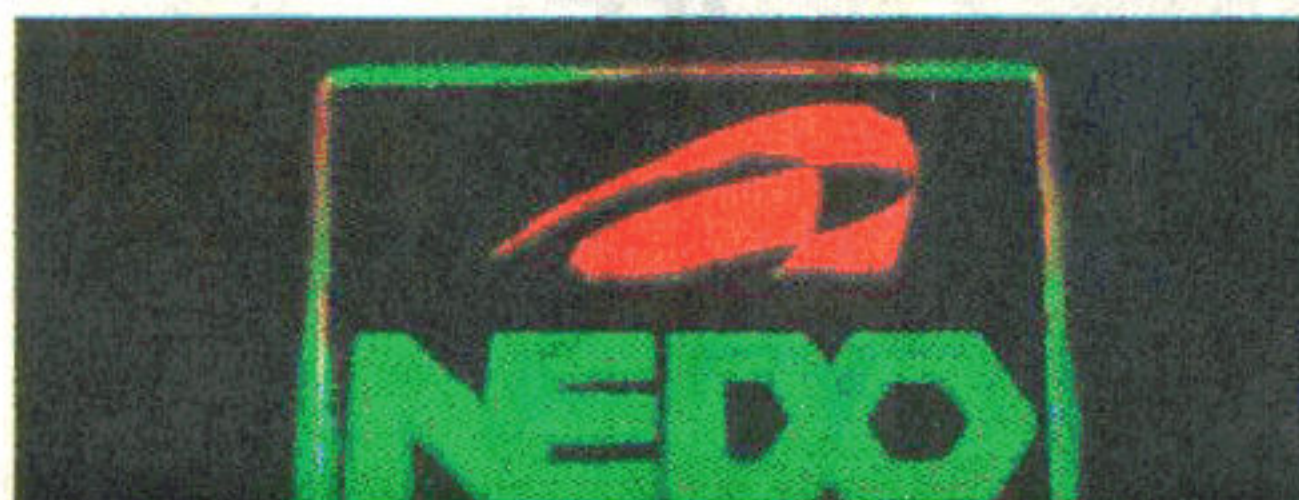
半導体ナノ粒子を内部に分散させた 蛍光ガラス。室内光での概観④と紫外光照射による発光時の様子⑤
